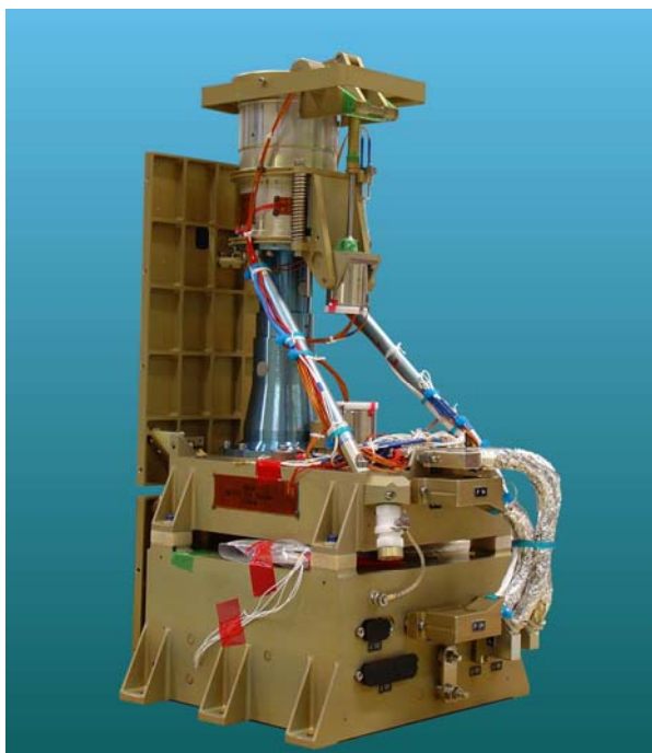
Abbildung 2: Das Kamerasystem an Bord der NASA-Raumsonde DAWN. Foto: NASA/DLR/MPS
