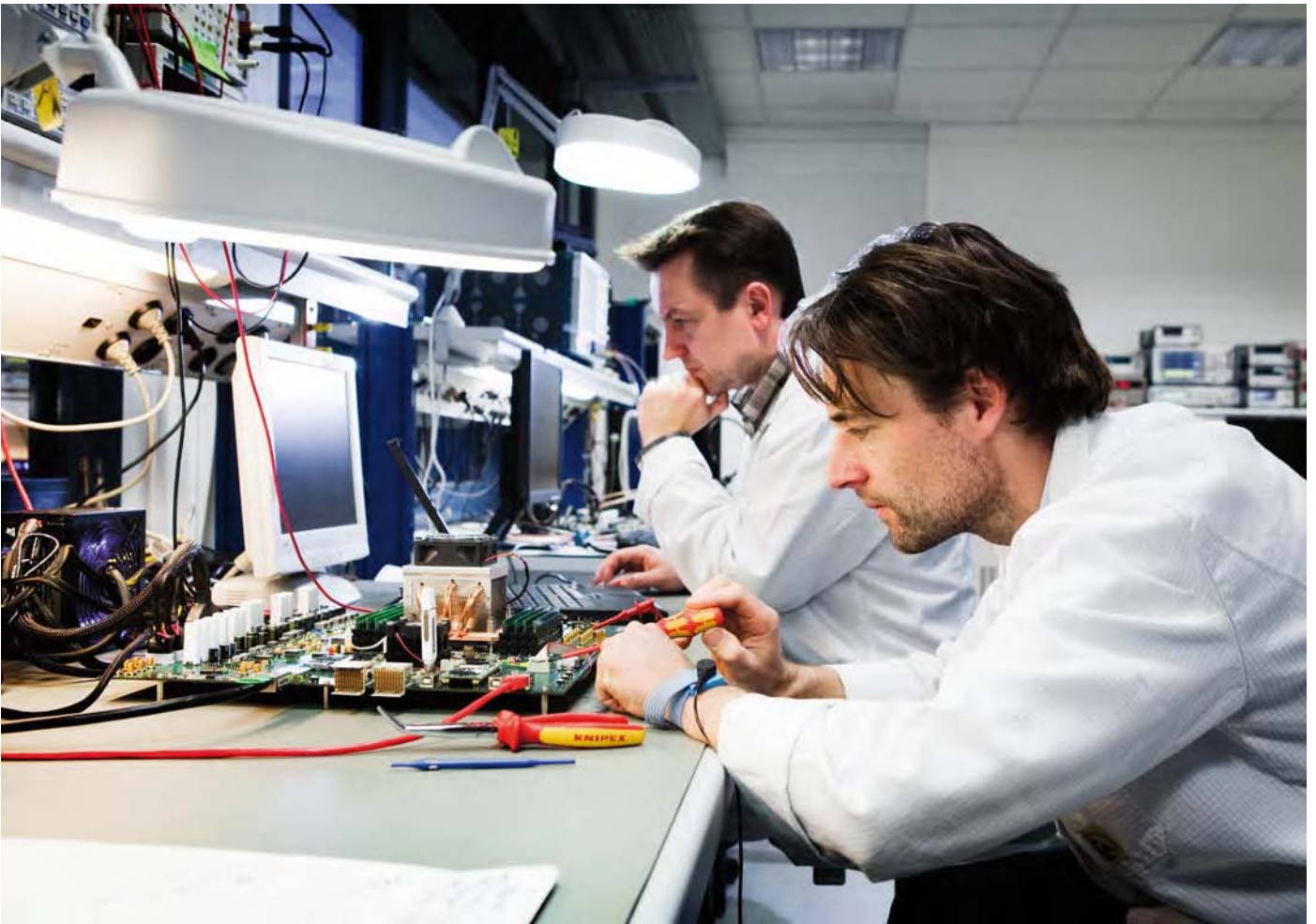
Der Multikernprozessor soll noch energieeffizienter werden, als er jetzt schon ist. Die Elektroingenieure Niklas Linkewitsch und Ulrich Bretthauer drosseln die Stromzufuhr am Board.
